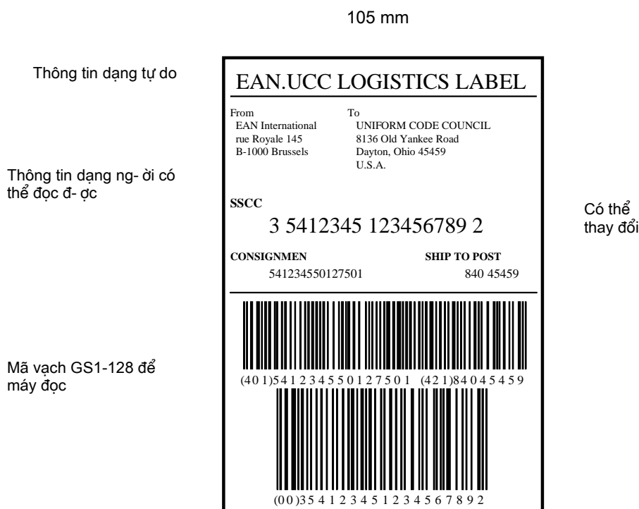
Hình 2.1.8: Kích thước, cấu trúc nhãn đơn vị logistic GS1
